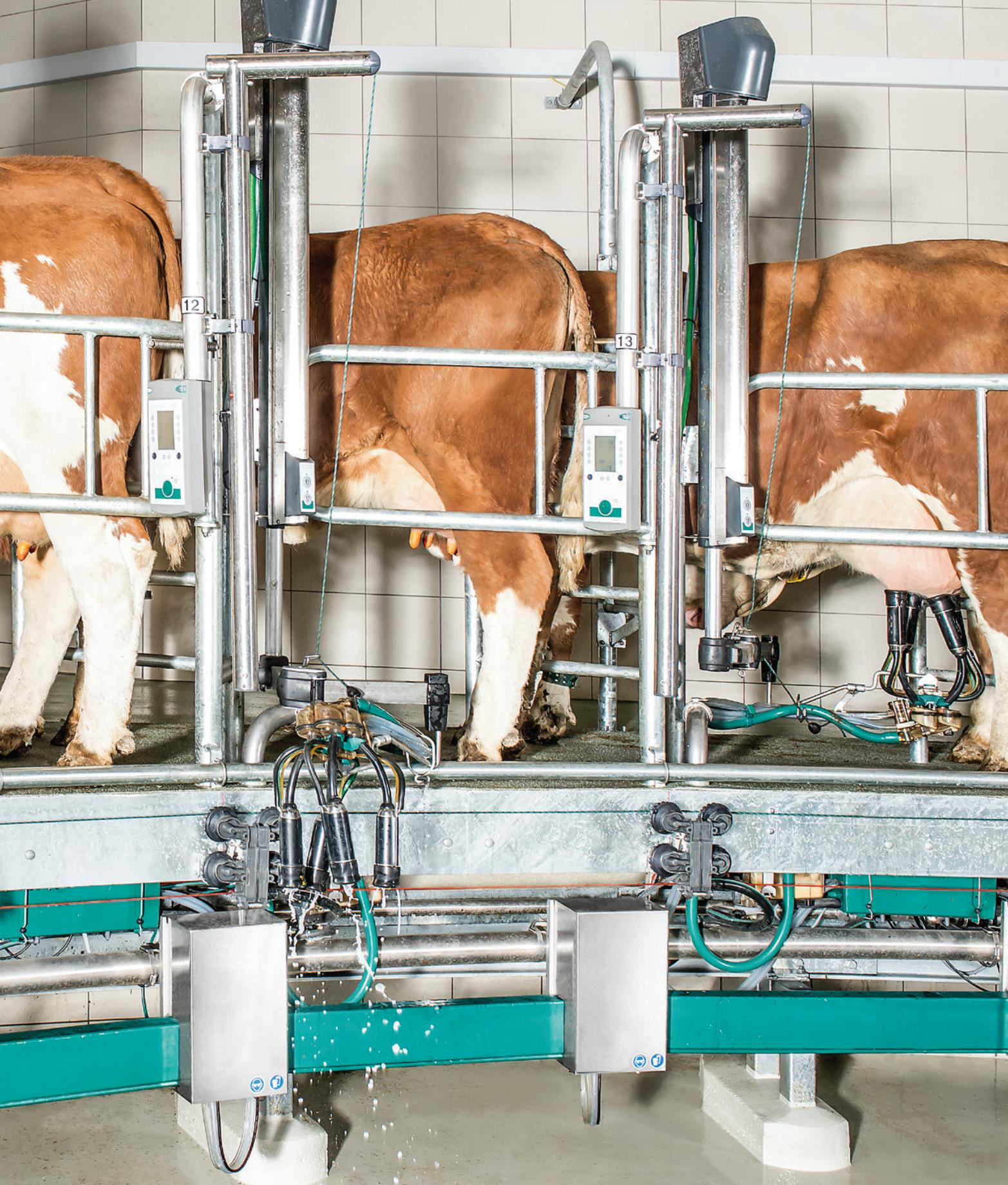
Das ApolloMilkSystem mit seiner revolutionären Dipp- und BackFlush-Technik ist die richtige Wahl für jeden Melkstand. Positionierungsarme wie z. B. der bewährte PosiCare erleichtern die Handhabung enorm, gewähr-
